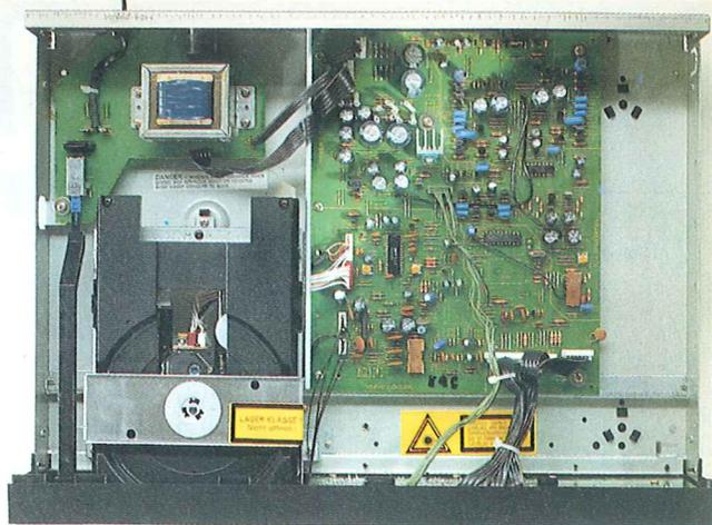
*Particolare del cassetto di caricamento. Notare il meccanismo di trascinamento ed al centro il gruppo di lettura.*
